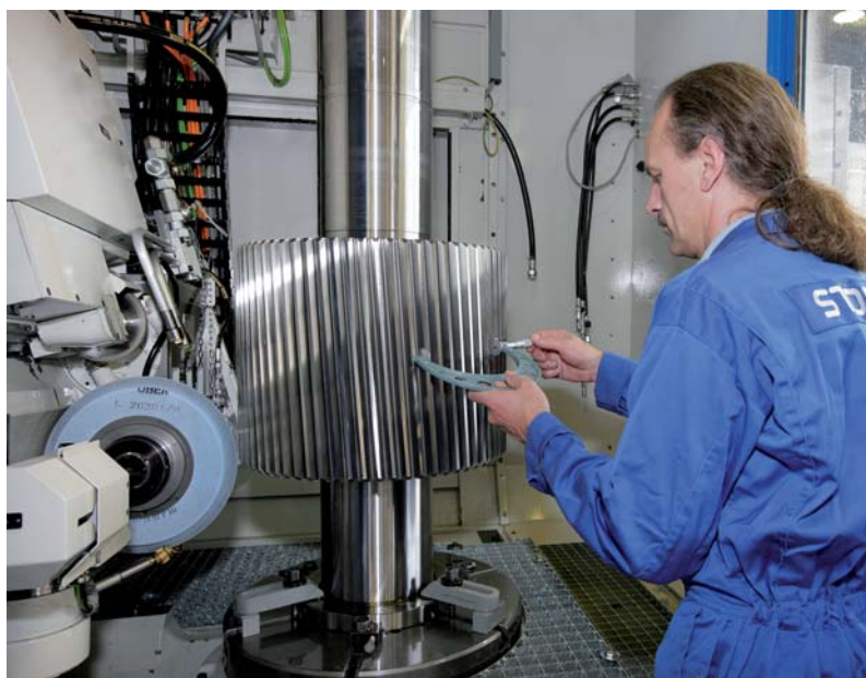
Leo Koolmees voert metingen uit met de Rollscan van Innogrind om tijdens het slijpproces mogelijke slijpbrand op te sporen. Intussen bekijkt Jos van Langh achter het beeldscherm de meetgegevens (foto's: Stork Gears & Services)
