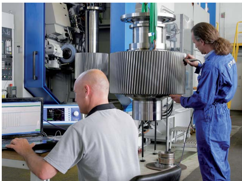
Leo Koolmees voert metingen uit met de Rollscan van Innogrind om tijdens het slijpproces mogelijke slijpbrand op te sporen. Intussen bekijkt Jos van Langh achter het beeldscherm de meetgegevens (foto's: Stork Gears & Services)
